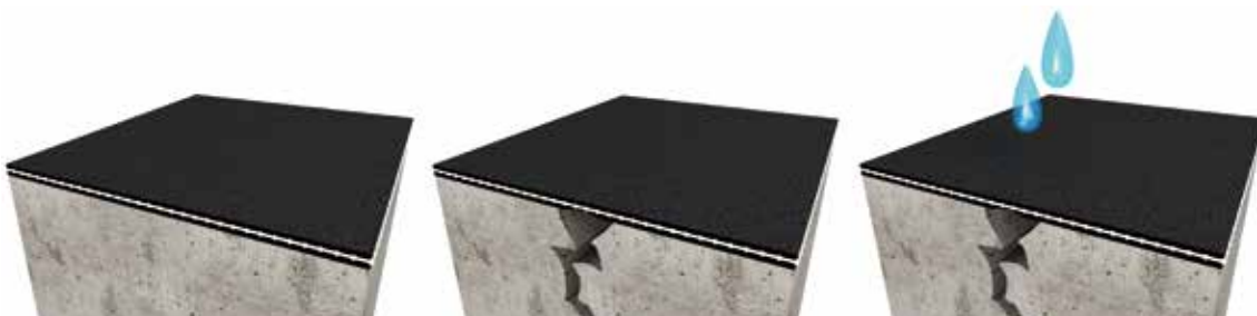
3. Halkeaman sillastus upotetun verkon ansiosta. Verkko erottaa ylemmän vedeneristyskerroksen halkeamasta ja auttaa merkittävästi kestäämään jatkuvaa vedenpainetta.
